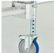
Ruedas Ø 150 mm, ajustables individualmente cada 12,5mm para un total de 175mm
